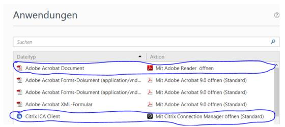
Die Einstellung für den Citrix ICA Client muß unbedingt auf den installierten Citrix Client verweisen. Die von Firefox bereitgestellte Anwendung ist nicht funktionabel. Die Einstellung, mit welchem Programm die PDFs geöffnet werden sollen, ist optional. Bitte beachten Sie, dass die hier getroffenen Einstellungen durch Updates des Programms Firefox verloren gehen können.
